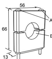
Distance entre les axes des trous : A =  $\varnothing$  45
