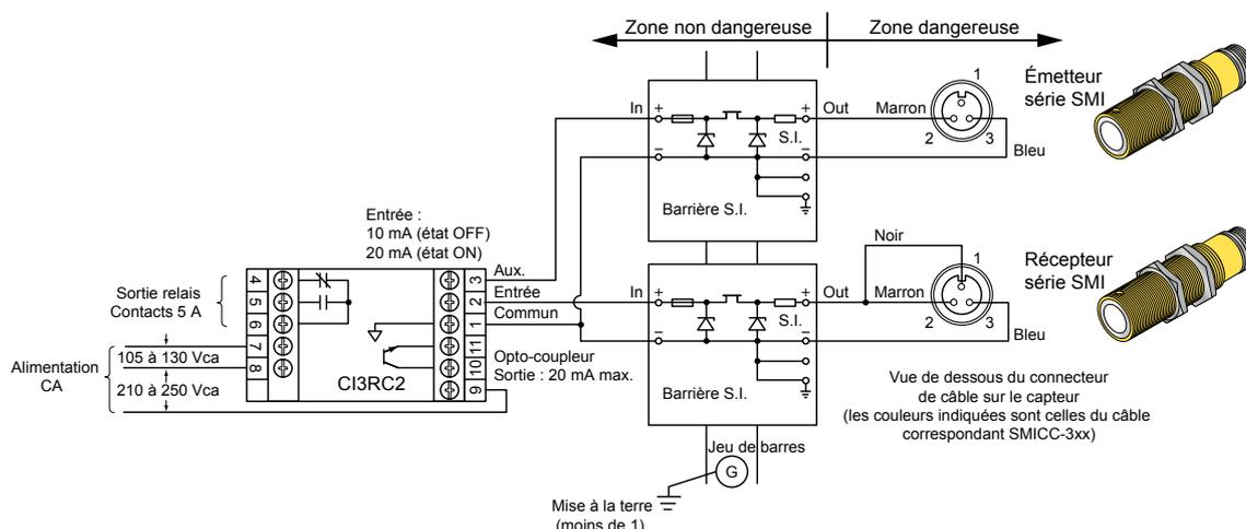
Illustration 4. Raccordement avec une barrière double voie
